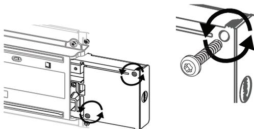
⑦ Retirez et conservez les deux vis de fixation de la partie arrière du boîtier de commande.
