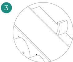
Veillez à isoler le col de connexion. Veuillez utiliser des bandes isolantes (laine de verre ou mousse de polyéthylène) de 25 mm d'épaisseur. La largeur de ces bandes isolantes est de 97 mm pour le plénum motorisé standard et medium et de 37 mm pour le plénum motorisé slim.
