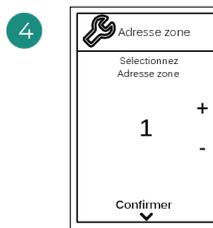
Sélectionnez la zone associée à ce thermostat. Chaque zone dispose d'une sortie de contrôle (sortie pour moteur ou relais de contrôle des éléments rayonnants).
