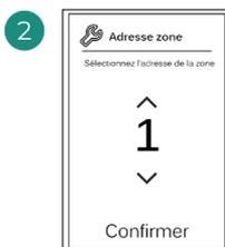
Sélectionnez la zone associée à ce thermostat. Chaque zone dispose d'une sortie de contrôle (sortie pour moteur ou relais de contrôle des éléments rayonnants).
