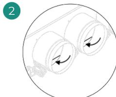
Retirez le col elliptique fixé à l'aide de vis. Retirez la tôle de protection qui recouvre la prise d'air extérieure et fixez le col elliptique.
