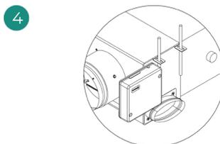
Fixez l'Easyzone au plafond à travers les pattes situées aux extrémités à l'aide de vis sans tête.
