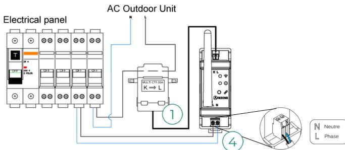
Le module est connecté à l'alimentation électrique ④ par une borne à 2 broches. Fixez les câbles à l'aide des vis de la borne, en respectant la polarité de celle-ci.
