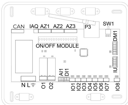
**Attention :** Si vous disposez d'un système Easyzone EZ8 vous aurez la possibilité d'incorporer un module de contrôle On/Off de zone (AZCE6ACCOFF) au boîtier de la platine centrale.
