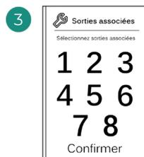
Le système permet d'associer une zone à plus d'une sortie de contrôle, le cas échéant. Il est possible de gérer plusieurs sorties de contrôle à partir d'un seul thermostat.
