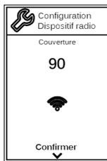
Vérifiez que la couverture réseau est optimale (30 % minimum).
