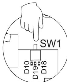
**Réinitialisation du système :** pour réinitialiser le système aux paramètres d'usine, maintenez enfoncé le bouton SW1 jusqu'à ce que la LED D19 arrête de clignoter.
