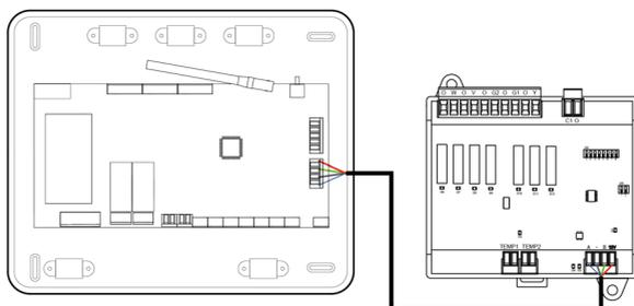
Les caractéristiques des relais de contrôle ① ② ③ ④ ⑤ sont 24/48 VCA hors tension. Pour contrôler des éléments de puissance supérieure, il est recommandé d'utiliser des contacteurs de la puissance que vous souhaitez contrôler.
