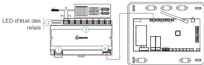
Les caractéristiques des relais de contrôle (3) sont I<sub>max</sub> de 10 A à 110/230 VCA hors tension. Pour contrôler des éléments de puissance supérieure, il est recommandé d'utiliser des contacteurs de la puissance que vous souhaitez contrôler. N'oubliez pas de connecter le neutre directement depuis le circuit jusqu'à l'élément que vous souhaitez contrôler.
