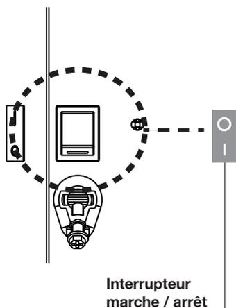
L'interrupteur marche/arrêt est situé à l'arrière de l'appareil.
