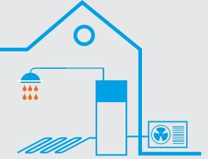
L'unité intérieure au sol est destinée aux productions de chauffage et d'Eau Chaude Sanitaire grâce au ballon intégré. La fonction rafraîchissement est disponible en option. Une version 2 zones est disponible pour contrôler 2 zones indépendamment l'une de l'autre.
