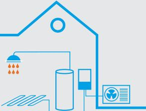
L'unité intérieure murale produit le chauffage. La production d'Eau Chaude Sanitaire assurée par un ballon déporté et la fonction rafraîchissement sont proposées en option.
