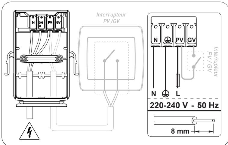
Veillez à faire correspondre les Phase (L), Neutre (N) et Terre (GND) de votre réseau électrique avec les fiches de connexion rapide, comme indiqué sur le schéma.
