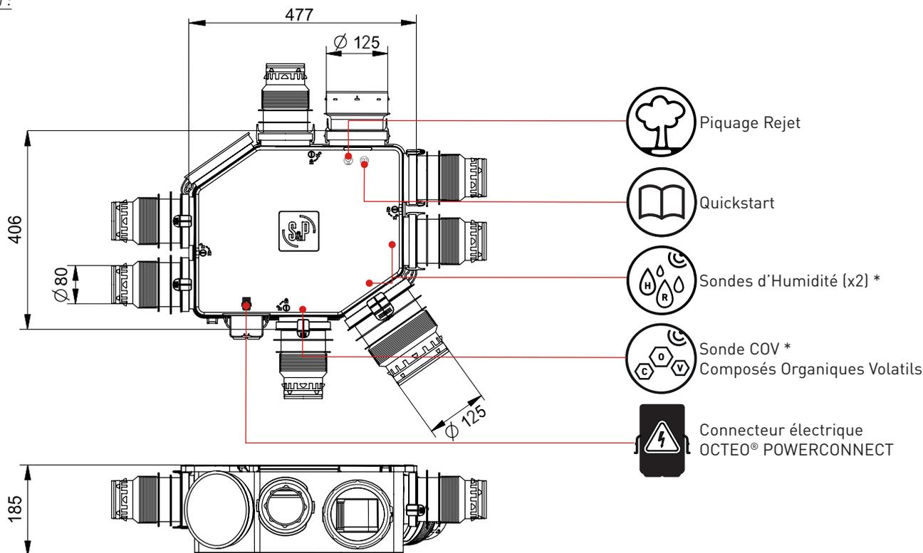
\* Les sondes d'Humidité et COV sont amovibles. Elles sont positionnées en sortie d'usine sur les orifices indiqués ci-dessus. Vous pouvez marquer le couvercle supérieur avec les stickers fournis. Si vous souhaitez les changer de place, reportez-vous au chapitre **10. POSITIONNEMENT DES SONDES** (page 17).
