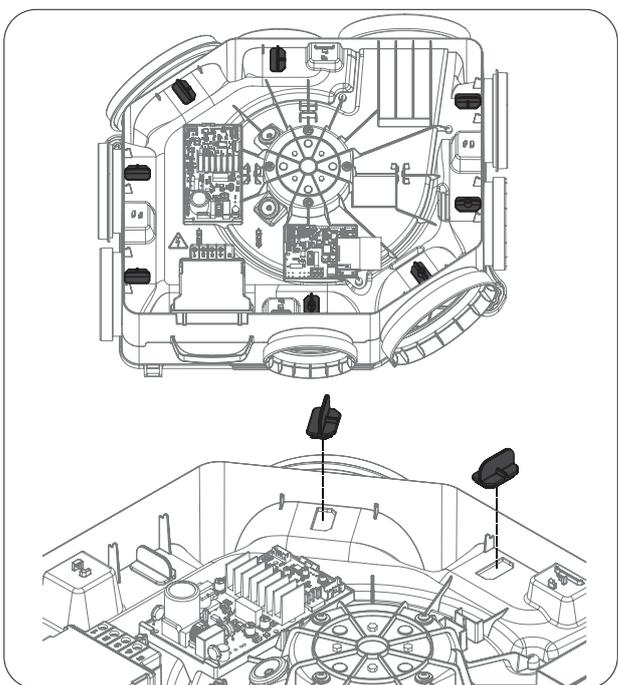
Grâce à sa modularité, l'OCTEO AUTO SERENITE ECOWATT RD vous permet de choisir l'emplacement des sondes sur les orifices que vous souhaitez utiliser.
