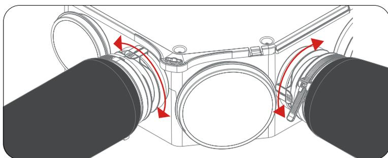
Gardez le contrôle sur l'orientation de votre réseau de gaines et procédez aux ajustements en faisant simplement pivoter le piquage OCTEO® POWERTWIST autour de son axe sans le déclipser.
