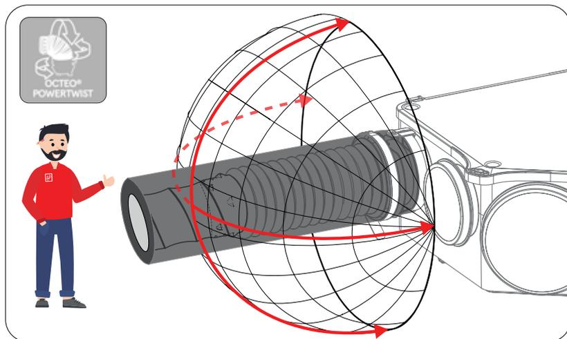
Utilisez le système breveté de chaque piquage OCTEO® POWERWIST pour orienter chacune de vos gaines vers les bouches. L'objectif étant de limiter au maximum l'angle à la sortie du caisson et le nombre de coudes dans votre réseau; tout en préservant le diamètre nominal de la gaine.
