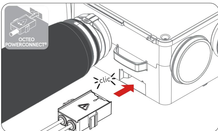
Vous pouvez à présent raccorder électriquement votre groupe d'extraction OCTEO AUTO SERENITE ECOWATT RD au réseau en clipsant le connecteur électrique OCTEO® POWERCONNECT.
