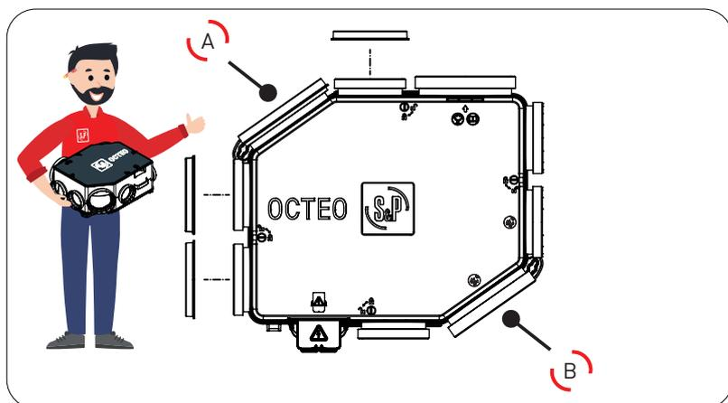
Mettez en place les bouchons sanitaires Ø 80 nécessaires, selon votre installation, pour ne laisser que les orifices destinés à accueillir les piquages d'extraction OCTEO® POWERWIST Ø 80. Le bouchon cuisine Ø 125 est déjà positionné.
