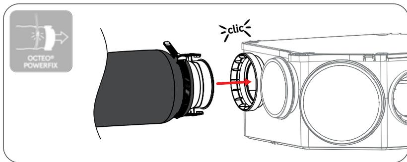
Vous pouvez connecter au caisson OCTEO AUTO SERENITE ECOWATT RD tous les piquages flexibles OCTEO® POWERWIST ainsi que le piquage de refoulement (rejet). Exercez une légère pression, jusqu'à entendre le "clac" garantissant la connexion et l'étanchéité entre les deux éléments.
