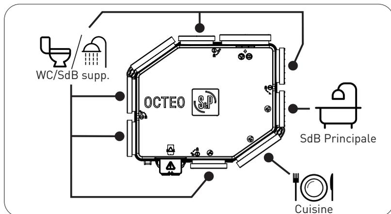
Positionnez votre OCTEO AUTO SERENITE ECOWATT RD dans votre logement (combles ou faux-plafond), en orientant les orifices de l'OCTEO AUTO SERENITE ECOWATT RD vers les pièces humides comme indiqué sur le schéma (ex : orifice cuisine vers bouche cuisine Ø 125).
