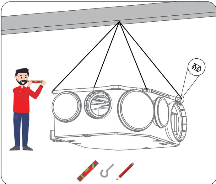
Pour un montage en suspension (combles), utilisez la cordelette fournie sur vos fermettes ou sur un crochet (non inclus) pour suspendre votre OCTEO AUTO SERENITE ECOWATT RD grâce aux 4 taquets situés sur le couvercle supérieur. Assurez-vous de l'horizontalité de votre installation, à l'aide d'un niveau à bulle.
