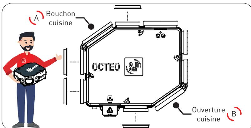
Mettez en place les bouchons sanitaires Ø 80 nécessaires, selon votre installation, pour ne laisser que les orifices destinés à accueillir les piquages d'extraction OCTEO® POWERWIST Ø 80. Le bouchon cuisine Ø 125 est déjà positionné.
