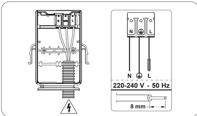
Veillez à faire correspondre les Phase (L), Neutre (N) et Terre (PE) de votre réseau électrique avec les fiches de connexion rapide, comme indiqué sur le schéma.
