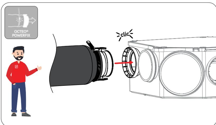
Vous pouvez connecter au caisson OCTEO HYGRO ECOWATT tous les piquages flexibles OCTEO® POWERTWIST ainsi que le piquage de refoulement (rejet). Exercez une légère pression, jusqu'à entendre le "clac" garantissant la connexion et l'étanchéité entre les deux éléments.
