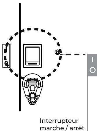
*L'interrupteur marche/arrêt est situé à l'arrière de l'appareil.*
