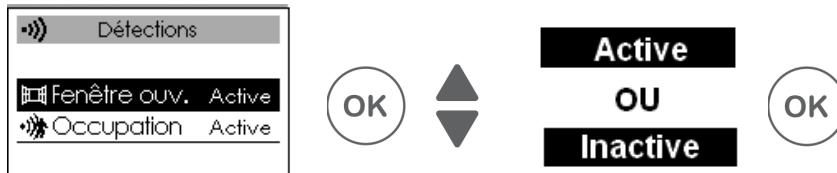
Bei der Sockelversion können Sie die Funktion "Lüftungserkennung" über den Programmiermodus aufrufen.
