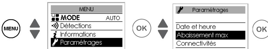
Permet de régler le niveau d'abaissement maximum de la température que vous souhaitez effectuer lors de vos périodes d'absences (de -2°C à -4°C). Par défaut, il est réglé à -3°C.
