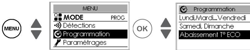
Mit dieser Funktion können Sie den Wert der Temperaturabsenkung einstellen, die außerhalb der Komfortbereiche wirksam werden soll (von -2 °C bis 9°C). Standardmäßig ist die Absenkung auf -3,5 °C eingestellt (wenn die Solltemperatur auf 19 °C eingestellt ist, wird sie außerhalb des Komfortbereichs auf 15,5 °C abgesenkt).
