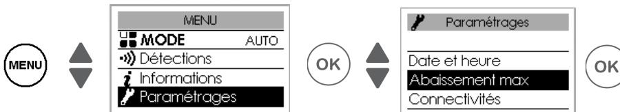
Diese Funktion ermöglicht es, den Wert der maximalen Temperaturabsenkung einzustellen, die während Ihrer Abwesenheit durchgeführt werden soll (von -2 °C bis -4 °C). Standardmäßig ist die Absenkung auf -3 °C eingestellt.
