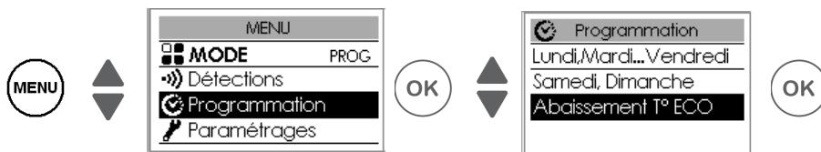
Permite regular o nível de descida da temperatura que deseja efetuar fora dos intervalos de conforto (de -2°C a 9°C). Por defeito, a regulação é de -3,5°C (se a temperatura de referência estiver regulada para 19°C, então, fora dos intervalos de conforto, ela descerá para 15,5°C).
