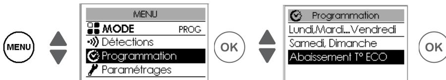
Permite ajustar el nivel de reducción de la temperatura que desea para los períodos que no sean los intervalos de Confort (de -2 °C a 9 °C). De forma predeterminada, el ajuste es -3,5°C (si la temperatura de consigna está configurada en 19 °C, fuera de los intervalos de Confort se reducirá a 15,5 °C).
