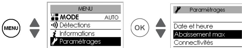
Permite ajustar el nivel de reducción máximo de la temperatura que desea para sus períodos de ausencia (de -2 °C a -4 °C). De forma predeterminada, este valor es -3 °C.
