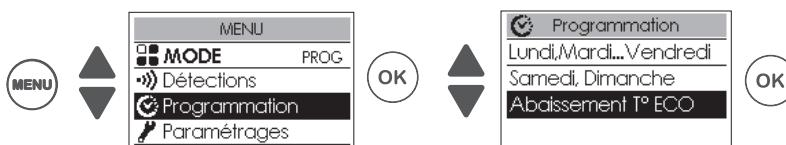
Permet de régler le niveau d'abaissement de la température que vous souhaitez effectuer en dehors des plages de Confort (de -2°C à -9°C). Par défaut, il est réglé à -3,5°C (si la température de consigne est réglée à 19°C, alors, en dehors des plages de Confort elle baissera jusqu'à 15,5°C).
