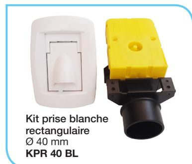
• Utiliser les kits prises KPC 40 ou KPR 40 avec un kit de liaison (KLI 51M/40F) permettant ainsi d'installer une prise murale dans une cloison placo de 74 mm (2 BA 13 + 1 rail de 48 mm) raccordée à un tube Ø 40 mm (TUB R40 2M) dans l'épaisseur de la cloison.
