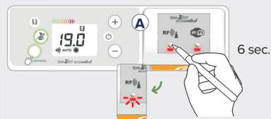
**7** SUR L'APPAREIL SMART ECOCONTROL® SUIVANT, INSÉRER UN MODULE CHAUFFAGE (C) DANS SON EMBLEMMENT. (voir notice d'utilisation de l'appareil) Le voyant lumineux clignote au rouge. Attendre que celui-ci ne clignote plus.
