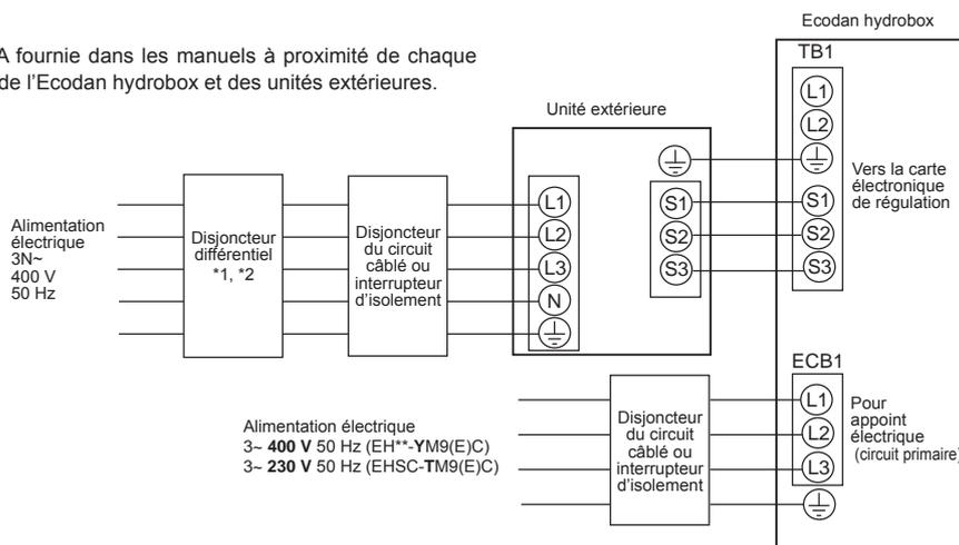
\*1 Si le disjoncteur différentiel installé ne dispose pas d'une fonction de protection contre les surintensités, installez un disjoncteur disposant de cette fonction sur la même ligne d'alimentation.
