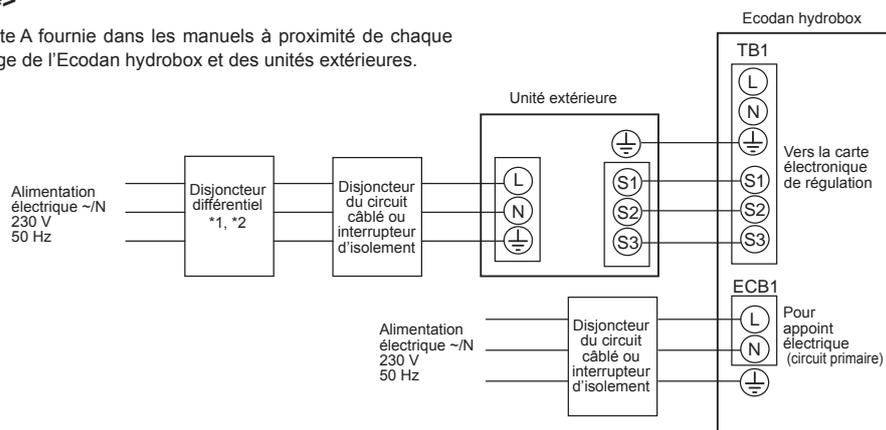
\*1 Si le disjoncteur différentiel installé ne dispose pas d'une fonction de protection contre les surintensités, installez un disjoncteur disposant de cette fonction sur la même ligne d'alimentation.
