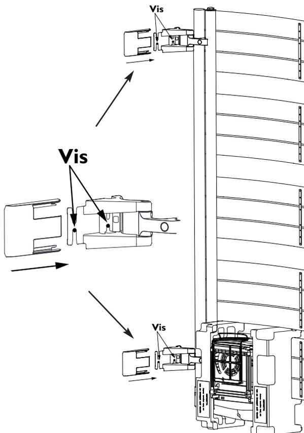
**3** Installez les caches esthétiques : plaquez les contre le mur et faites les glisser au maximum jusqu'à la butée.
