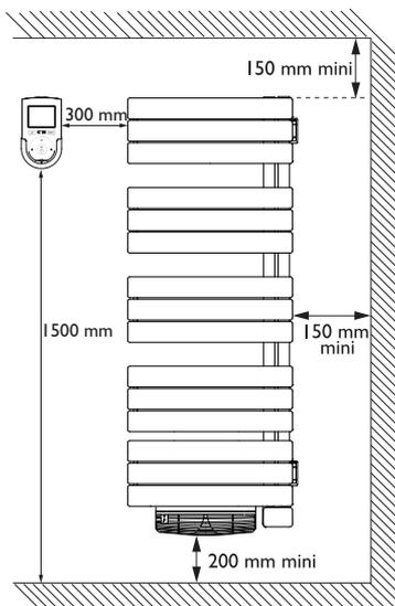
La distance de 300 mm entre l'appareil et la commande digitale est préconisée pour un fonctionnement optimal de votre appareil.
