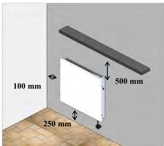
Une fois choisi l'emplacement de l'appareil, retirez l'emballage. Placez le radiateur contre le mur et fixez-le au mur selon le schéma suivant :
