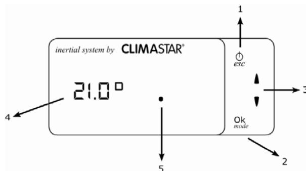
1 –TOUCHE “⏻ /ESC” : Mise en marche et arrêt de l’appareil. Permet aussi le retour au menu précédent.
