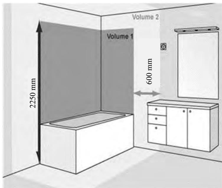
Lors de la pose de l'appareil au mur, veuillez respecter la distance minimale indiquée dans le schéma suivant.
