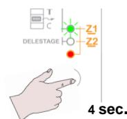
Appui de 4 secondes sur le bouton jusqu'à ce que le voyant de la zone sélectionnée clignote rapidement.
