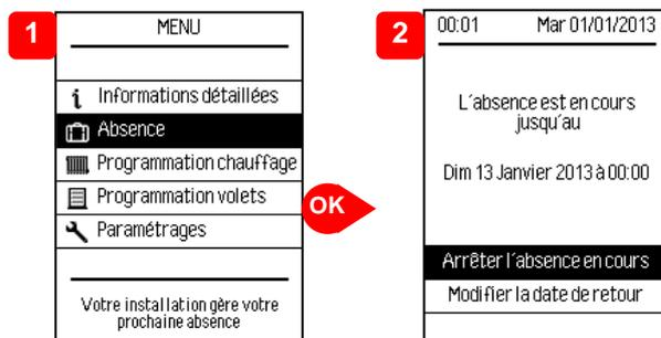
**Nota :** Par défaut, la programmation des volets sera désactivée pendant l'absence. Cependant il est possible de modifier ce comportement dans « Paramétrages »/« Traitement en absence »/« Volets ». En revanche, le paramétrage du Chauffage et de l'Eau chaude n'est pas modifiable.
