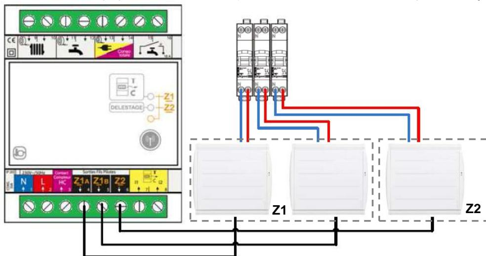
**Nota** : La puissance des appareils de chauffage de la zone 1 doit être répartie entre les voies Z1A et Z1B pour optimiser la fonction de délestage.
