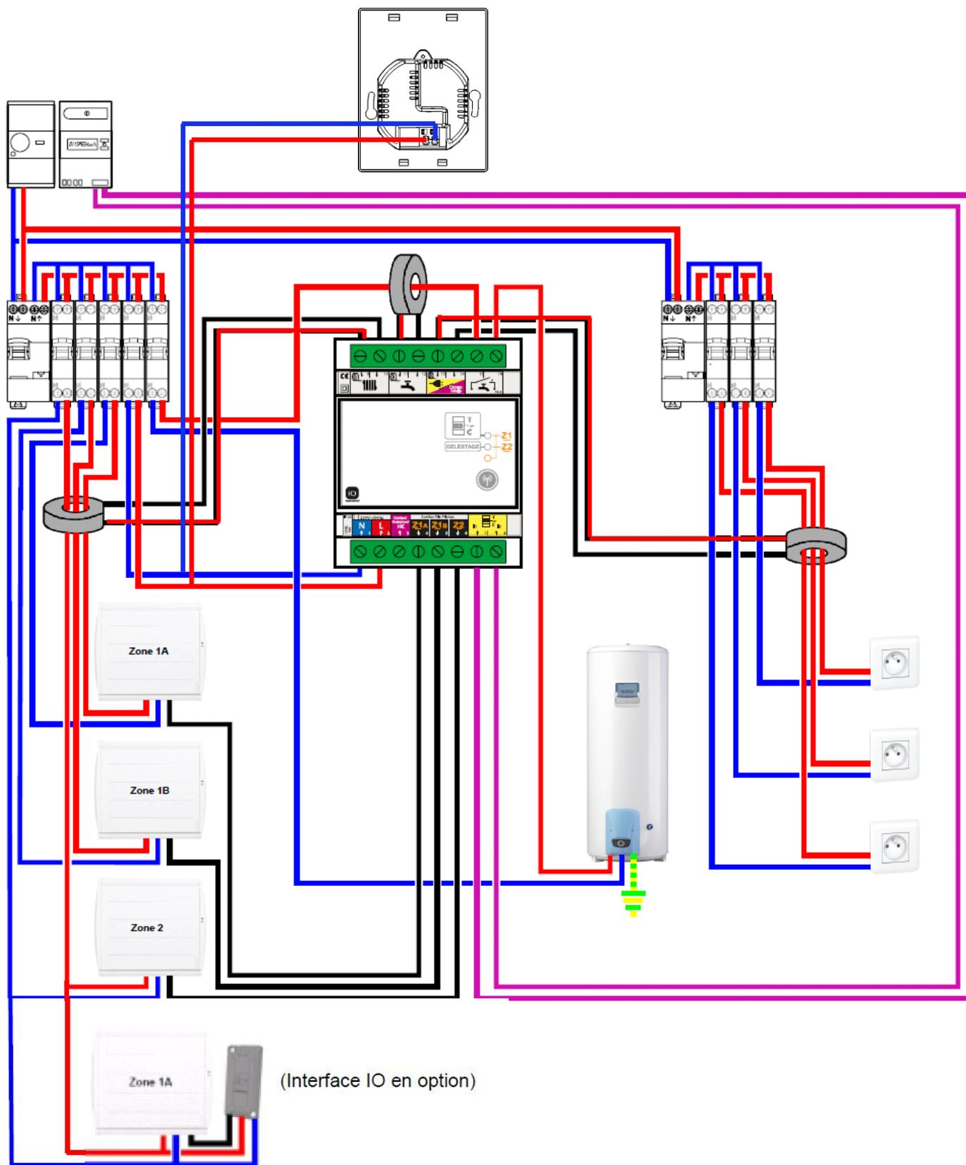
La commande d'ambiance et le boîtier modulaire doivent être raccordés et alimentés pour poursuivre la configuration de l'installation.
