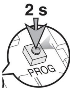
Appui de 2 secondes sur « PROG » à partir d'une commande de volet qui est déjà programmée au moteur.
