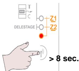
Appui de 8 secondes sur le bouton jusqu'à ce que le voyant rouge s'allume. (Celui-ci s'éteint automatiquement après 5 secondes). Avant de faire le retour en mode usine, le voyant rouge ne doit pas être allumé.
