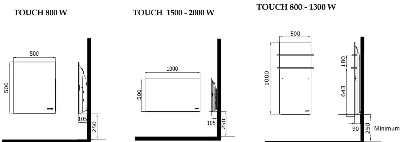
L'installation doit être faite dans les règles de l'art et conforme aux normes en vigueur dans le pays d'installation.
