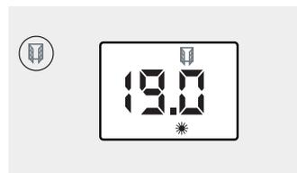
*i* Cette fonction arrête automatiquement le chauffage en cas de détection d'une chute brutale de la température dans la pièce (Ex : une fenêtre ou une porte ouverte).
